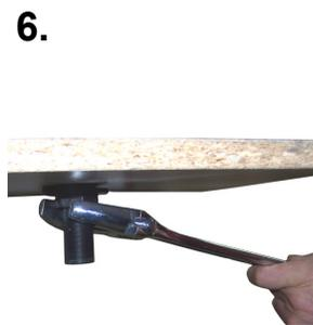
Avec une clé à molette, serrer la noix de fixation. Attention de ne pas utiliser une force excessive
