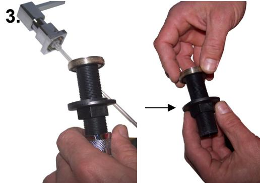
Dévisser la bouteille, la noix de fixation noire et retirer la rondelle de caoutchouc
